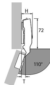
Scharniereinsprünge H / Türeinsprünge T bei Distanz D = 0 mm und Topfabstand C = 3 mm
